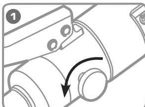
Поверните винт сброса давления в положение «Открыто».
