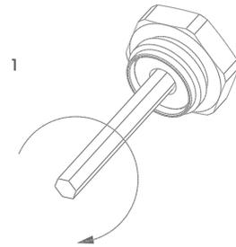
1 При помощи шлицевой отвертки открутить полностью и вынуть стопорный винт, головка которого находится внутри шестигранного гнезда вентиля. С помощью шестигранного ключа до упора завернуть вентиль (а).
