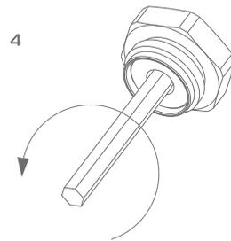
4 Отвернуть головку вентиля до упора шестигранным ключом (d).
