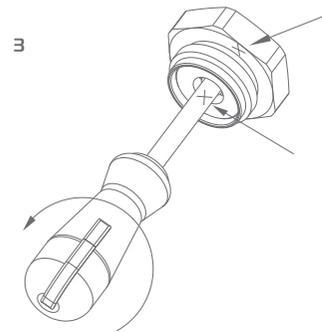
3 Отвернуть винт на требуемое количество оборотов, в соответствии с «Графиком настройки расхода стопорным винтом» (с).
