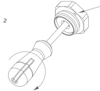
2 Снова вставить винт и отверткой закрутить его до упора. В данном положении сделать маркером метку на корпусе вентиля (b)
