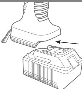
Вставьте аккумулятор в корпус инструмента до щелка, при этом прозвучит характерный сигнал и сработает световая индикация. Аккумулятор устанавливается только в одном положении.
