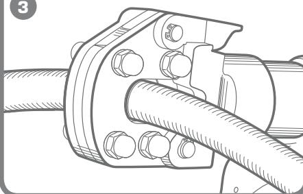
Нажмите на кнопку «ПУСК» и держите нажатой ее до срабатывания механизма автоматического сброса давления. При этом раздается характерный щелчок.
