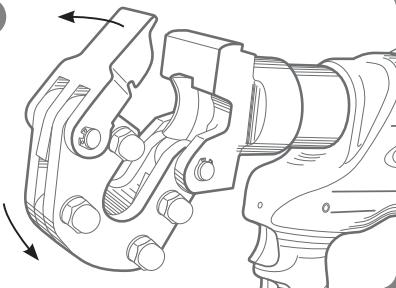
Откройте рабочую голову, нажав на фиксатор. Установите трос или пруток в рабочую зону. Закройте рабочую голову, защелкнув фиксатор.
