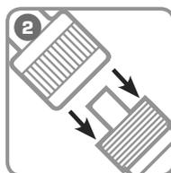
2. Отсоедините рукав помпы от исполняющего инструмента и установите заглушку на БРС.
