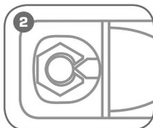
**Создайте давление помпой, разрежьте гайку**
