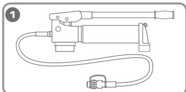
**Установите инструмент по возможности на ровной, плоской поверхности. Такое положение обеспечит устойчивость насоса во время работы**
